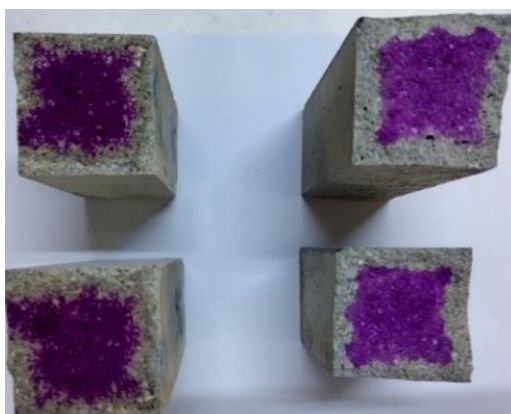
Figura 5-1. Determinarea cu ajutorul fenolftaleinei a grosimii stratului carbonatat, la doi ani de la demararea procesului
